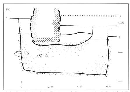
10: Burg Zug. Schnitt längs des Angriffsstollens unter der Turmmauer. 1 Aktueller Turmboden 1979, 2 Rekonstruierte Oberkante des Geländes zur Zeit des Angriffes, 3 Oberkante nach Abtragen von anstehendem Baugrund im 18. Jh., 4 Oberkante des Baugrundes 1979.
