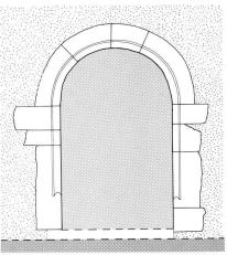
11: «Hinterer Schwert-Turm», Südfassade, das mächtige romanische Portal mit Dreiviertelrundstab (erstes Viertel 13. Jahrhundert) wurde im späten 13. Jahrhundert in Zweitverwendung hier eingebaut. Lichtmass: 1,54/1,70 bis 2,50 m.
