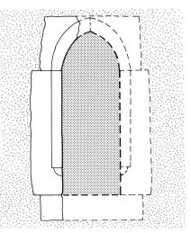
9: «Hinterer Schwert-Turm», einfaches Spitzbogenfenster im dritten Obergeschoss der Südfassade, frühes 14. Jahrhundert. Rekonstruiertes Lichtmass: 40/85 bis 112 cm.
