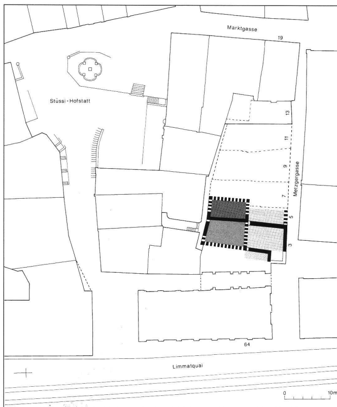
Abb. 12: Metzgergasse 3, «Tanzforst». Grundriss mit der Lage und Abfolge der beobachteten Steinbauten und der 1933 abgebrochenen Altstadt Häuser.
