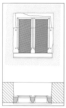
Abb. 5 Ansicht und Schnitt durch ein Pfostenfenster von 1318.
