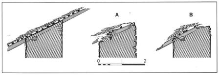
Cagliatscha, Schnitte durch Dachkonstruktion. Rechts Befund bei Sparren Nr. 6, Mitte Befund bei Sparren Nr. 5, links Rekonstruktion.
