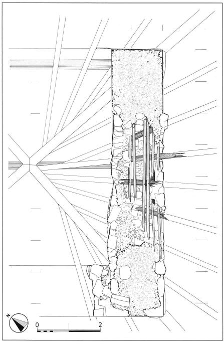
Cagliatscha, Dachpartie abgedeckt. Reste der hölzernen Dachkonstruktion mit Mauerschwelle, Sparren und Hälblingen. Rekonstruktion des ursprünglichen Pyramidendaches.
