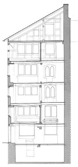
Schnitt gegen Osten durch das heutige Haus. Die Verjüngung der südlichen Brandmauer gibt die Höhe des ursprünglichen Pultdaches an, Massstab 1:125.
