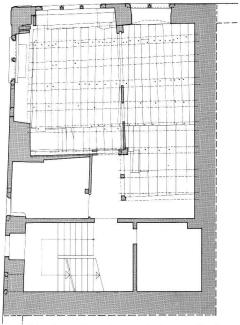
Grundriss des 1. Obergeschosses mit den ursprünglichen Balken- und Bretterlagen sowie der Bohlenwand, Massstab 1:125.
