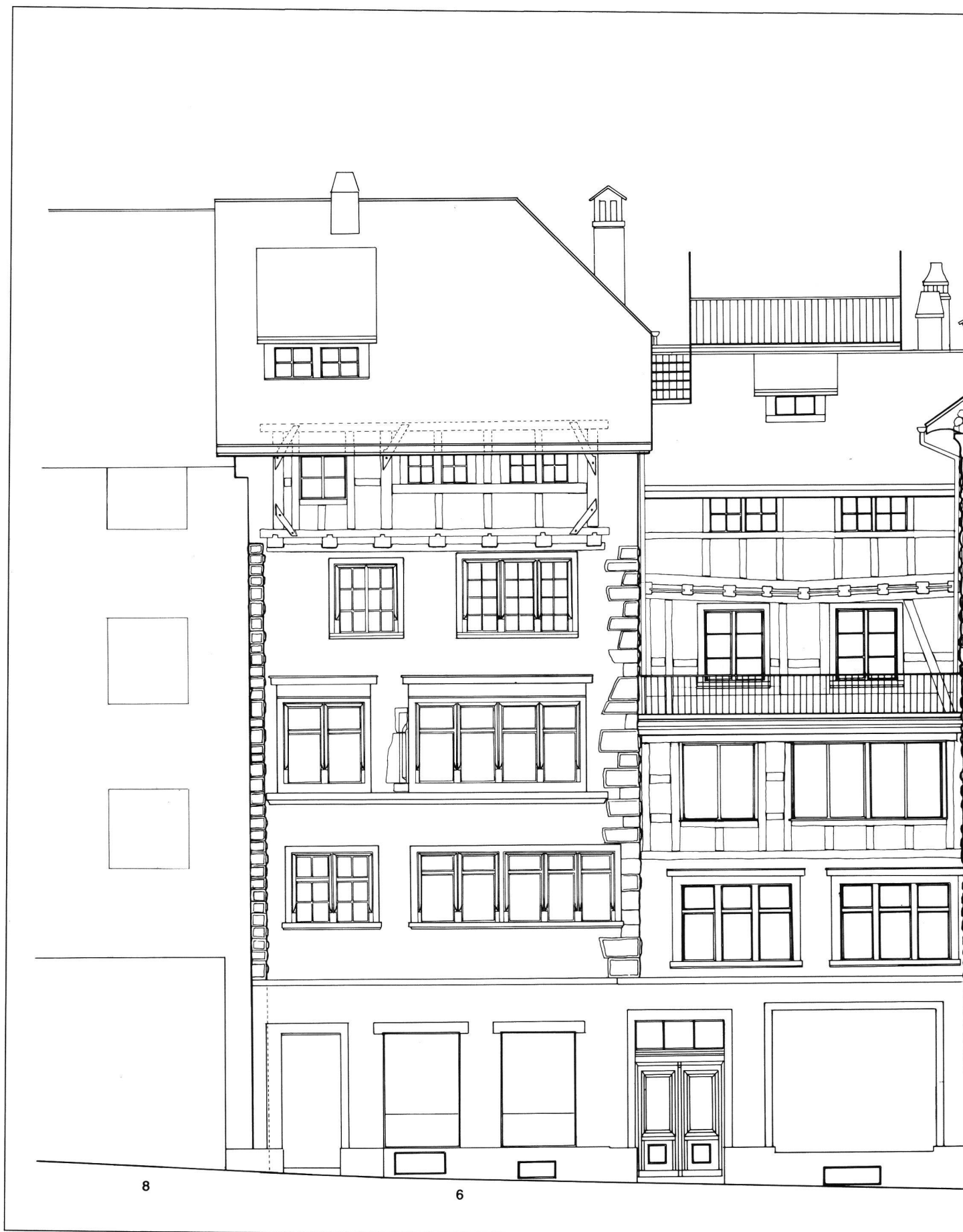
Abb.7: Ansicht von der Rosengasse an die Nordfassaden des «Kleinen Regenbogens», des Verbindungsbaus, des «Glentnerturms» und des limmatseitigen Anbaus. Massstab 1:100 (Umzeichnungen: Anita Engelhard, Zürich)
