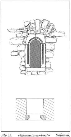
Abb. 19: «Glentnerturm»-Fenster Ostfassade 2. Obergeschoss, Massstab 1:50.
