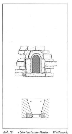
Abb. 18: «Glentnerturm»-Fenster 2. Obergeschoss, Massstab 1:50.
