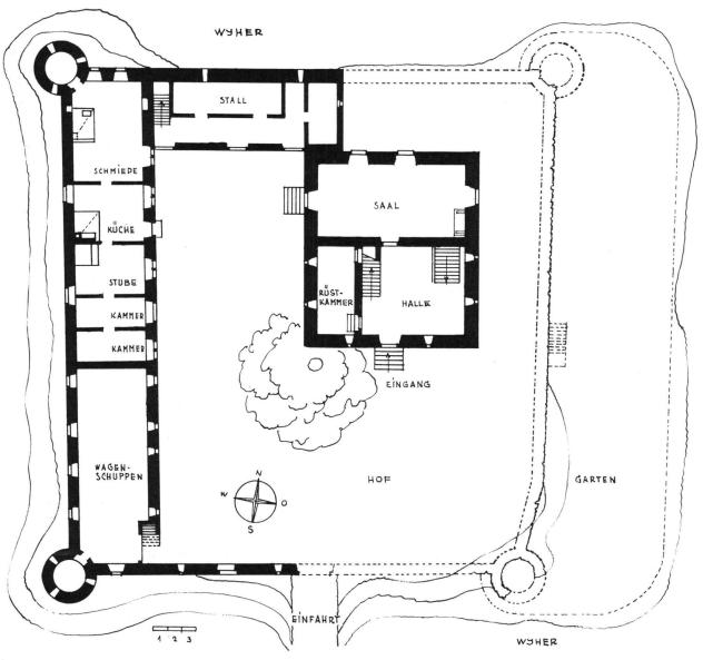
Grundriss von Schloss Wyher mit dem erhaltenen Ökonomiegebäude, mit Herrenhaus und Verbindungsbau, rechts die abgebrochenen Rundtürme mit Wehrmauer.
