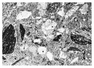
«Romanischer Putz», Dünnschliff im Polarisationsmikroskop, parallele Polarisatoren. Weniger und feinere Risse als beim «Tschudi-Putz», mehr kristallines Sandmaterial von besserer Beschaffenheit. Im Bindemittel weit mehr Feinstanteile. 23:1.
