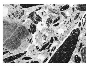
«Tschudi-Putz», Dünnschliff im Polarisationsmikroskop, parallele Polarisatoren. Zum größten Teil Verrucano-Sand, sehr viele Risse (weiß), links Kalkknollen. 23:1.
