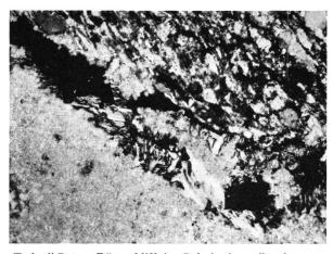
«Tschudi-Putz», Dünnschliff im Polarisationsmikroskop, gekreuzte Polarisatoren. Rechts oben Verrucano-Korn, links unten Bindemittel (Kalk) mit sehr wenig Feinstkorn. Schräg von links oben nach rechts unten Riß (leer = schwarz) mit sekundären Calcitbildungen (nadelige Kristalle), was auf zu nassen Mörtel hinweist. 250: 1.
