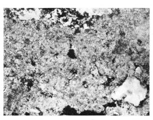
«Romanischer Putz», Dünnschliff im Polarisationsmikroskop, gekreuzte Polarisatoren (Risse usw. schwarz). Helle Partie rechts unten = Quarzkorn. Im Bindemittel ziemlich viel Feinstkorn. 250:1.
