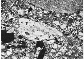
Schloß Sargans. Polarisations-Mikroaufnahmen von Mörtel-Dünnnschliffen, Maßstab genau 12,25:1.
