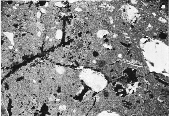
Schloß Sargans. Polarisations-Mikroaufnahmen von Mörtel-Dünnschliffen, Maßstab genau 1:25,5.
