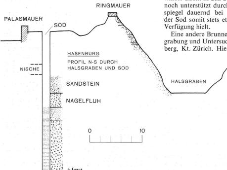
Hasenburg, Schnitt NS durch Halsgraben und Sod
