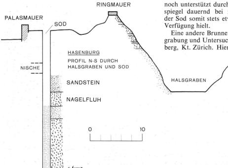
Hasenburg, Schnitt NS durch Halsgraben und Sod
