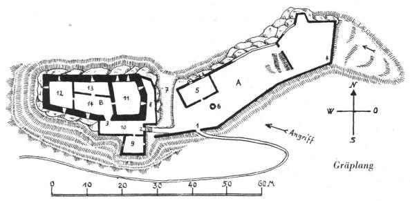
Legende zum Lageplan: 1, 2, 3 = Burgtore; 4 = Ringmauer der Vorburg; 5 = Nebengebäude; 6 = Brunnen; 7 = Halsgraben (jetzt teilweise aufgefüllt); 8 = Vormauer; 9 = Mauerturm (kontrolliert alle 3 Tore); 10 = Torzwinger; 11 = Teil des Palas, der vermutlich zum Bergfried ausgestaltet war; 12, 13, 14 = Wohn- und Vorratsräume.
