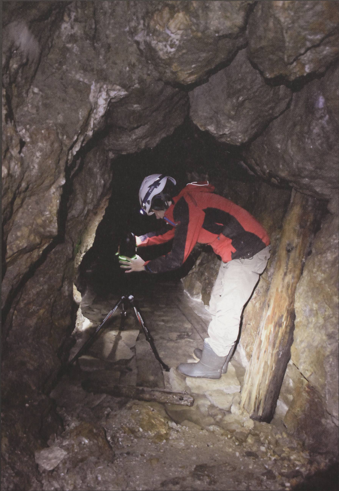
Anja Buhlke im Stollen Fliden beim digitalen Vermessen des Stollens mittels 3D-Scanner.
