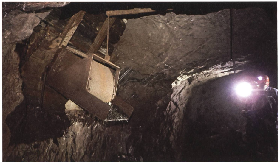
Links: Aufstieg am Freitag zum Wolfsloch-Eingang des Gonzen-Bergwerks (ZOGRAPHOS 2019). Rechts: Stopper eines Silos von dem aus die Loren mit Abbaumaterial aus höheren Galerien beladen wurden (STOLZ 2019).
