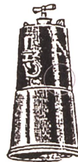
Wasserbehälter oben, Karbidgehäuse unten
