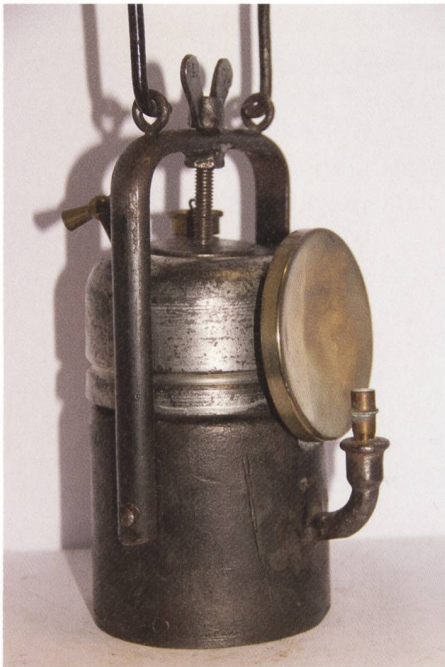
Fig. 37 Die Pollux-Lampe mit dem Wassertank aus gedrücktem Eisenblech.
