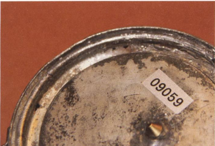
Fig. 36 Besonders auffällig sind die unerfreulichen Rostspuren am Wassertankboden.
