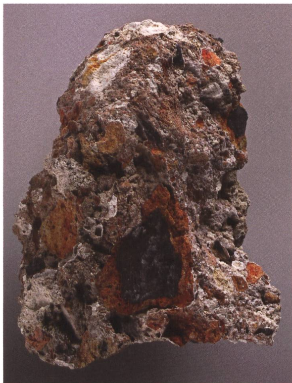
Fig. 5. Scorie du four à chaux de Fonteinte montrant la combustion incomplète de l'antracite.
