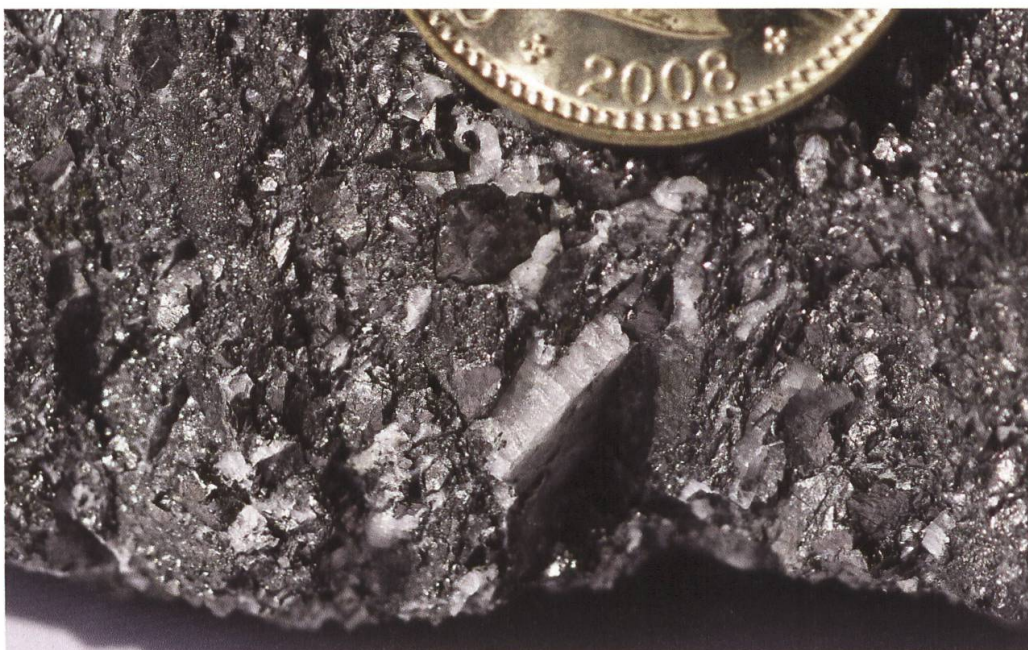
Fig. 1. Breckziöser Anthrazit mit hohem Quarzanteil, wie man ihn in den Bergwerken von Turtmann und Iserables antrifft.
