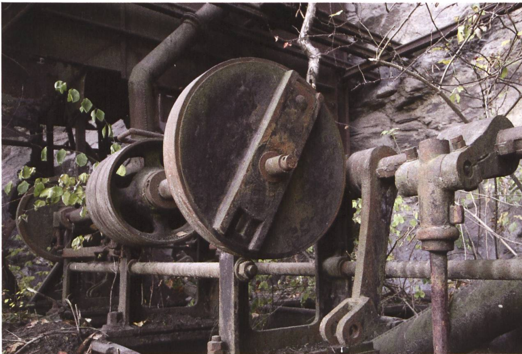
Fig. 3. Kolben-setzmaschine in der alten Aufbereitungsanlage von Chandoline. Hier stehen neben Goppenstein die letzten Kolben-setzmaschinen aus dieser Zeit.
