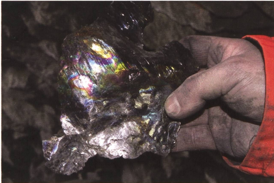
Fig. 2. Tektonisierter Anthrazit. Gut sichtbar die Rutschharnische mit glänzenden, graphitischen Oberflächen. Die bunt schillernden Bereiche lassen auf lokal vorhandene ölige Bestandteile schliessen.
