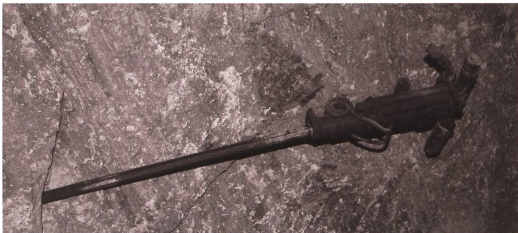
Fig. 22. Foto eines Flottmann Bohrhammers. Solche und ähnliche Modelle kamen oft während des zweiten Weltkrieges im Waliser Bergbau zum Einsatz
