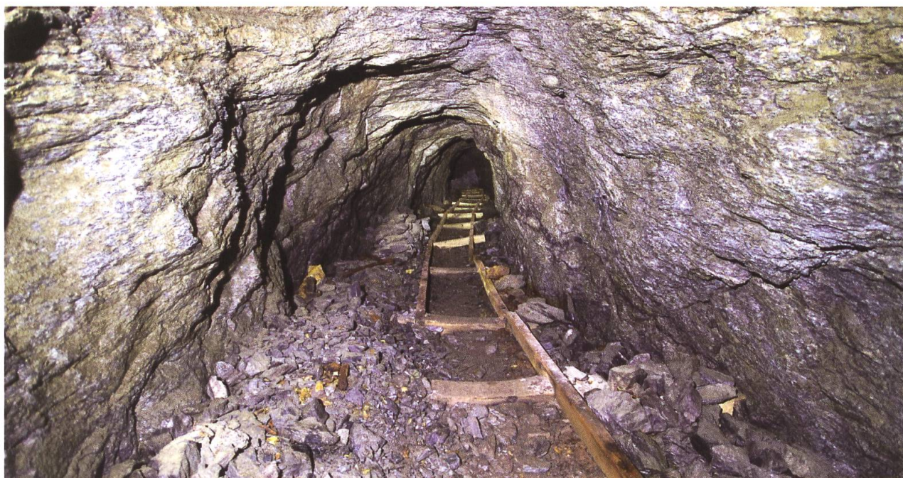
Fig. 16. Im Querschlag 1 (Sohle 1) finden sich noch heute gut erhaltene Holzschienen.
