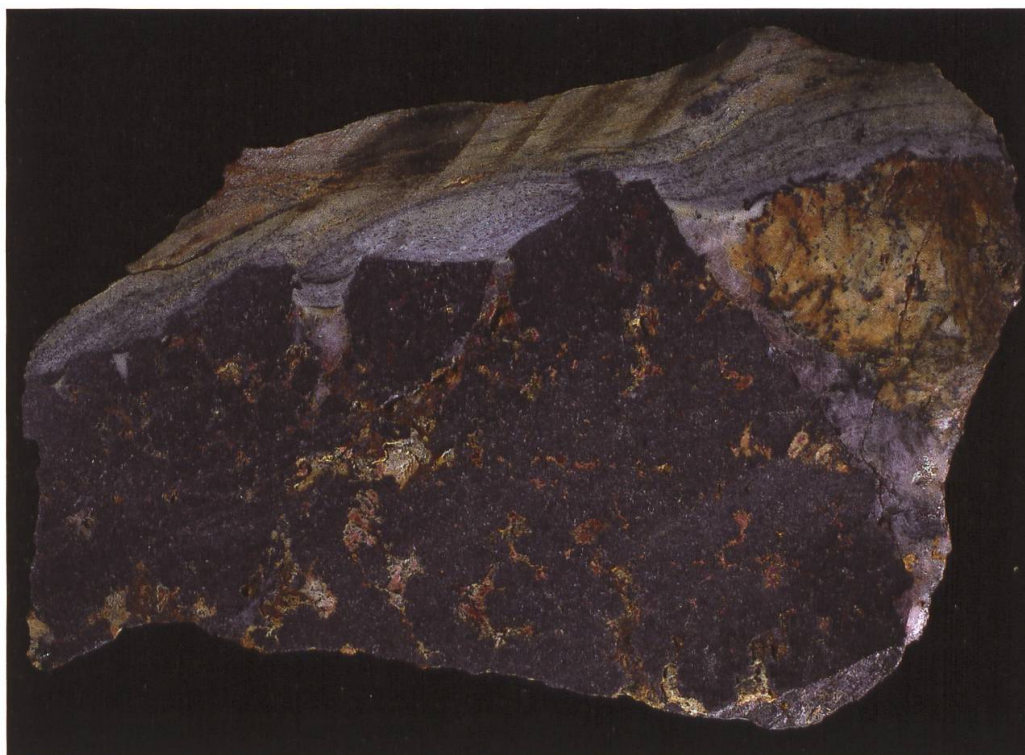
Fig. 7. Bloc scié de minerai de Kaltenberg, montrant la structure du dépôt métallifère, avec skutterudite dominante et gersdorffite associée. Les interstices sont comblés par des carbonates, de l'érythrite et des hydroxydes de fer. On distingue une digestion partielle des épontes de gneiss lors de la mise en place de la minéralisation et une fracturation tardive, marquée par l'apparition d'une veine de quartz (à droite) et d'un remplissage par des carbonates brun-jaune. Largeur de l'image: 16 cm. Collection du Musée cantonal de géologie de Lausanne.
