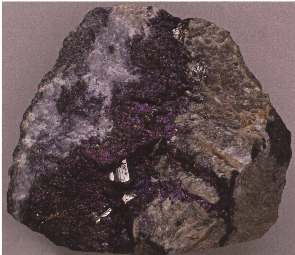
Fig. 5. Cristaux centimétriques d'arsénopyrite inclus dans une veine de bornite violacée. On distingue également des grains métalliques dorés de chalcoppyrite. Largeur de l'image: 7 cm. Collection du Musée cantonal de géologie de Lausanne.
