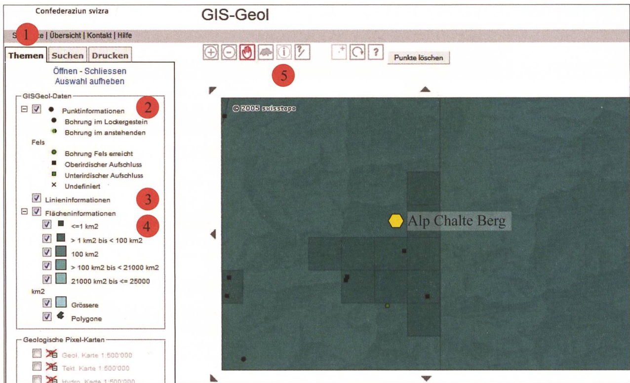
Fig. 10. Gis-Geol mit dem Ausschnitt Turtmanntal. Bei den Themen (links (1)) sieht man, dass Informationen zu Punkten (z.B. Bohrungen (2)), Linien (z.B. Tunnel (3)) oder Flächen (z.B. Karten, Dissertationen usw. (4)) abgerufen werden können. Mit dem Info-Knopf (i in einem Kreis (5)) kann man die Informationen zu den Daten abrufen (Klicken oder Fläche aufziehen). Die Informationen werden unterhalb der Karte als Liste dargestellt – wer nicht nach unten scrollt, sucht vergeblich danach. Oftmals ist es von Vorteil, die Auswahl etwas einzuschränken. Findet sich ein interessantes Dokument, kann man online sein Interesse bekunden und eine Anfrage an die Informationsstelle via Web-Formular ausfüllen und abschicken. Dies allerdings nur, wenn vorher ein oder mehrere Einträge selektiert wurden ((6) siehe Fig. 11).
