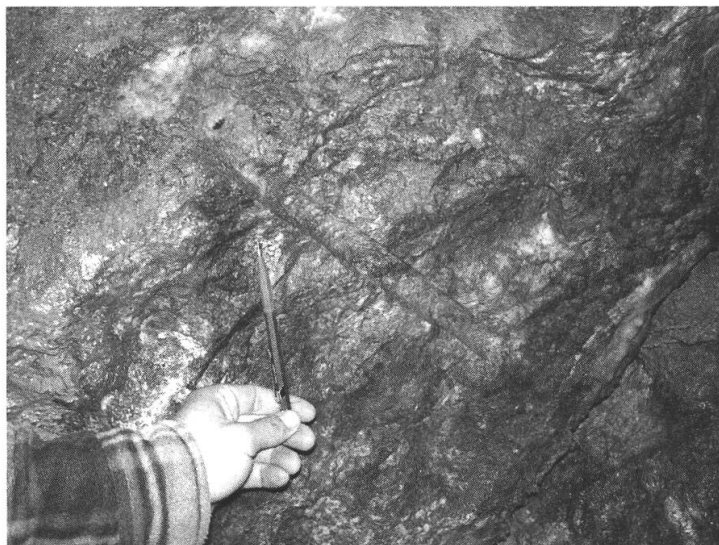
Figura 16. Fori da mina nella Miniera del Pozzo.
