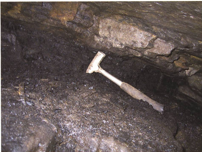
Abb. 11: Das Kohlenflöz im Oberbergstollen. Rechts vom Hammer sind noch ehemalige Abbauspuren erkennbar (Foto R. Kündig).
