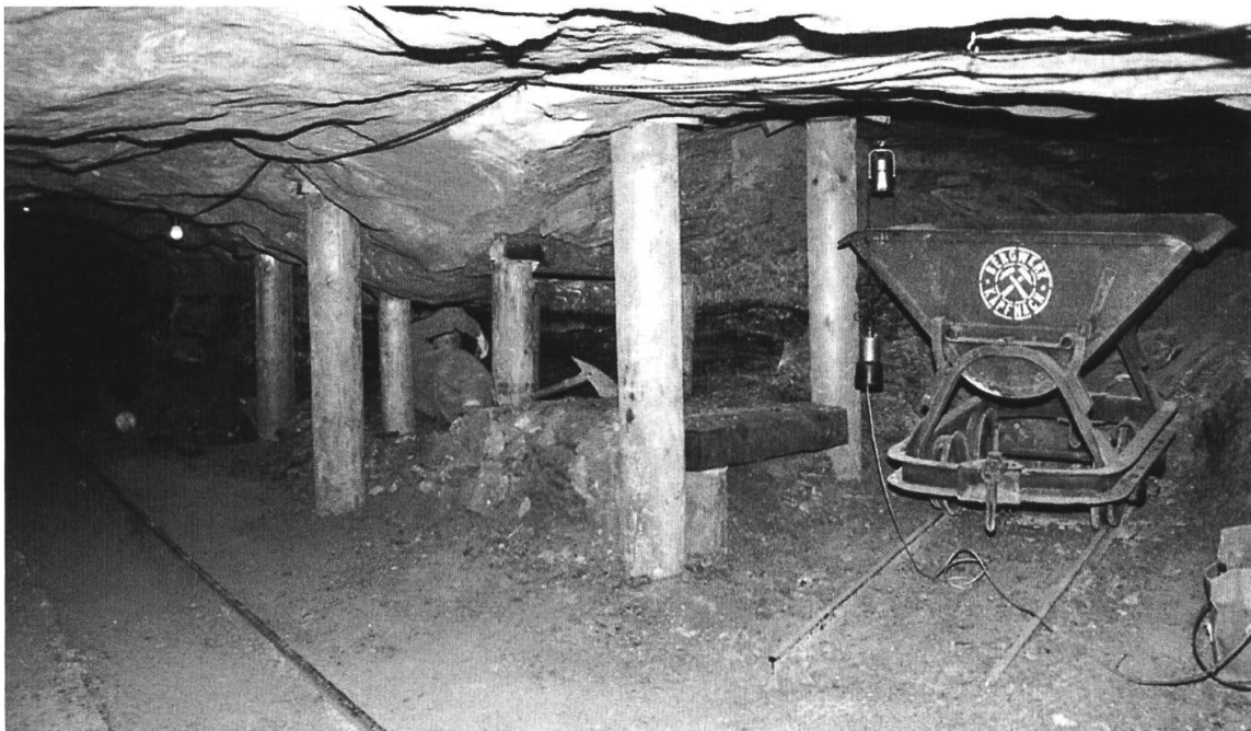
Abb. 22: Häuer in rekonstruiertem Abbauschlitz mit Lore im Nebenstollen.
