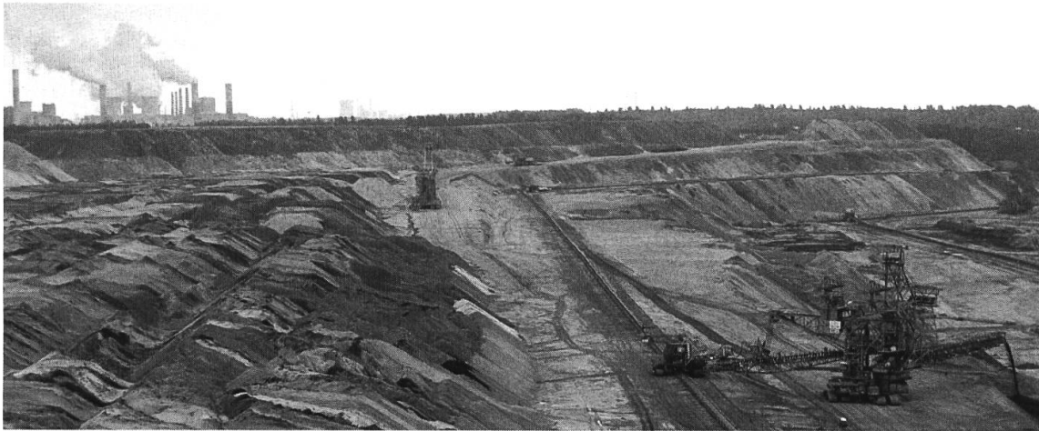
Abb. 7 a,b: Braunkohlentagebau im Ruhrgebiet (Hambach und Garzweiler der Rheinbraun AG). Das Kohlenflöz ist an der Basis im oberen Bild sichtbar. Mehrere Schaufelradbagger mit Tagesleistungen von je 240'000 Tonnen lagern das überliegende Gesteinsmaterial um (unteres Bild). Die Kohle wird über kilometerlange Förderbandanlagen zu dem im Hintergrund sichtbaren Kohlenkraftwerk transportiert. Bilder: R. Kündig.
