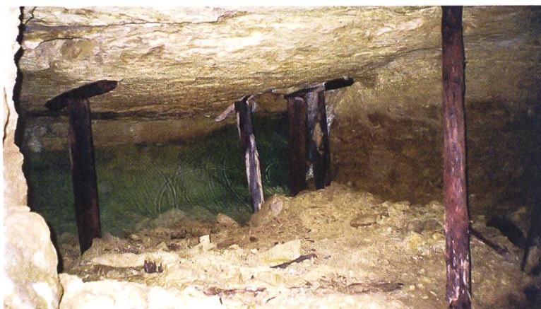
Fig.9 :Chambre d'exploitation avec soutènement en bois dans la mine des Seignots (Les Longevilles/Doubs) avant pompage. Cliché C. Jacquemin-Verguet.
