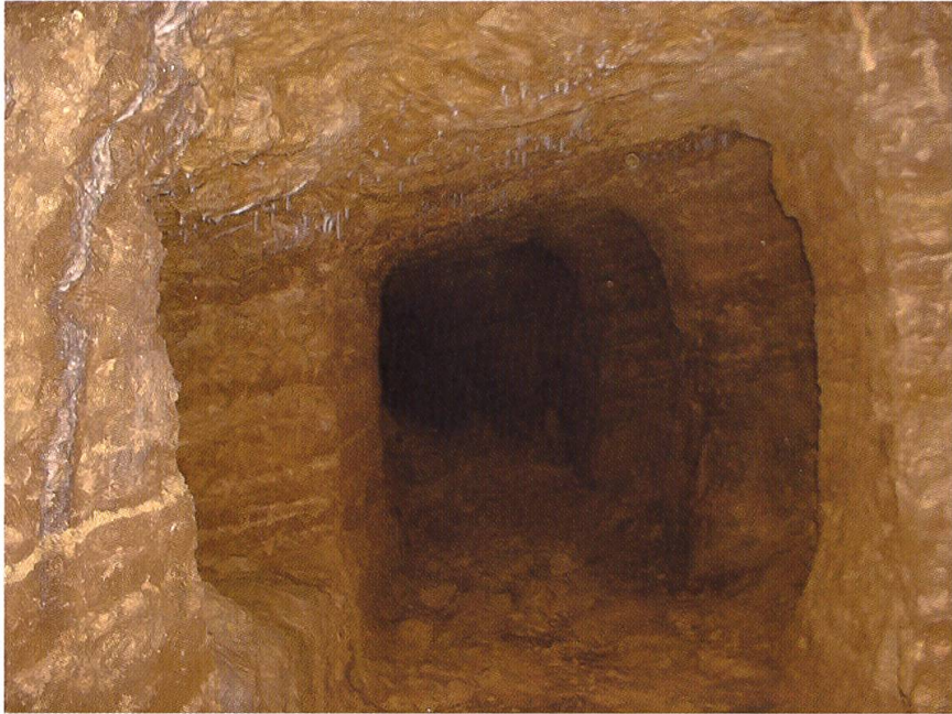
Fig. 1 : Aspect de la couche de «Limonite du Valanginien» exploitée à Oye-et-Pallet. On remarque clairement l'alternance des niveaux clairs (calcaires) et sombres (ferrugineux).
