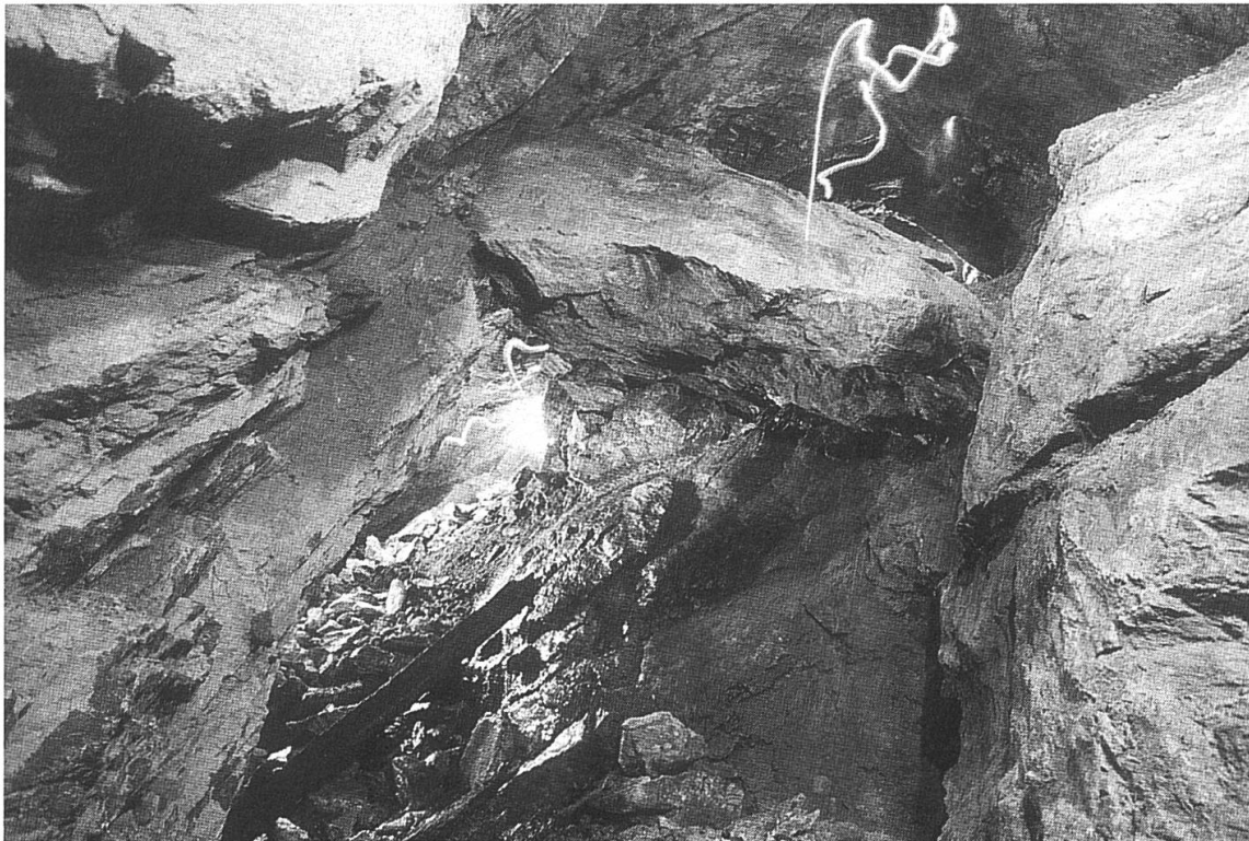
Photo 17: Le niveau II de la mine de cobalt-nickel de Grand-Praz. L'exploitation des lentilles minéralisées a créé des vides parfois assez considérables, comblés en partie par des blocs tombés du plafond, mais aussi, à l'arrière-plan, par des remblais de stériles laissés par les anciens mineurs ( 1986). Photo: Stefan Ansemet
