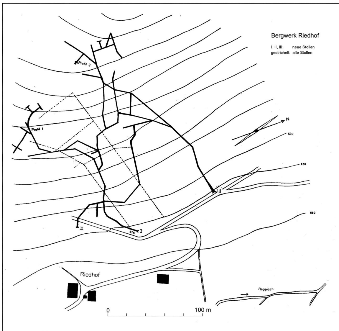
Abb. 16: Grundriss der Stollenanlage 1921. Mit I, II und III sind die drei neuen Stollen der Abbauperiode 1917–1921 bezeichnet. Gestrichelt eingezeichnet sind die alten Stollen aus der ersten Abbauperiode 1786–1814. Nach Letsch & Ritter, 1925.
