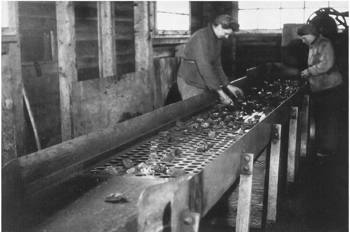
Abb. 40: Ab 1943/44 sind die Klauberinnen in der neuen Klauberei an der Sortierarbeit. Diese Förderband- und Rütteltischanlagen waren für die damalige Zeit modern (Planung und Montagearbeiten durch die Firma U. Ammann, Langental).
