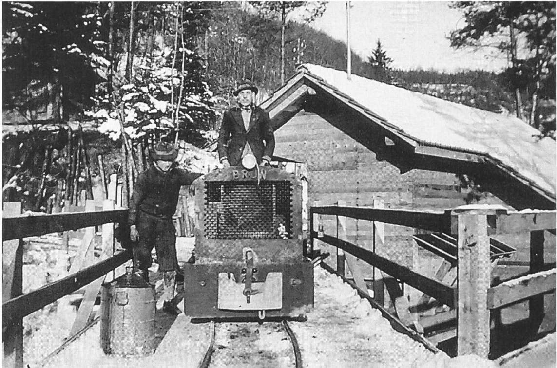
Abb. 36: Maschinist auf der Brun-Lokomotive, daneben der Bremser. Diese Lok kam vor allem untertag zum Einsatz. Sie transportierte die «Hunde», die einiges kleiner waren als die Kippwagen, von den Nebenstollen zu den Bahnhofskavernen. Dank kleinen Abmessungen und geringem Gewicht konnte sie in den Abbaugebieten gut auf Drehscheiben manövriert werden.
