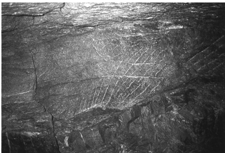
Schrämspuren über dem Erzhorizont in den Abbauten auf Guppen aus dem 16. Jahrhundert (Foto D. Imper).
