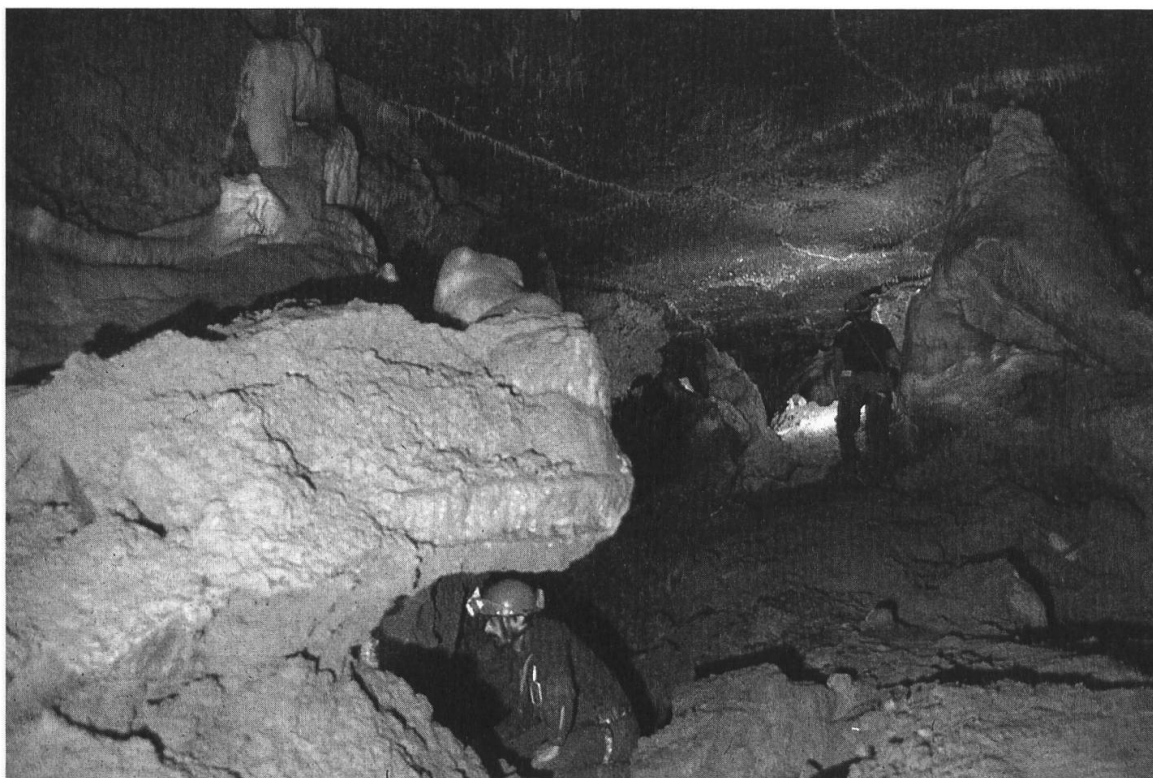
Fig. 3 : Onans (Doubs) : Mine de fer pisolithique. Grotte-mine de «Coteau Couillery». Le plancher stalagmitique de cette cavité a été défoncé pour en extraire le minerai de fer sous-jacent. Au premier plan, reliquat d'un front de taille sous le plancher stalagmitique d'origine. Au centre : voie de roulage (Photographie : D. Morin).
