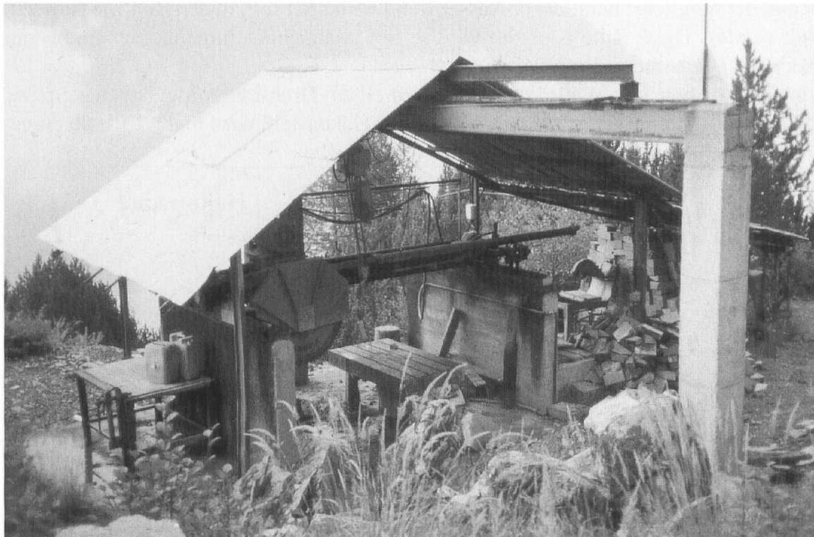
Fig. 7: Moderne Bearbeitung von Lavezsteinrohlingen im Val Malenco mit Stein- und Drahtsägen (Alpe Pirlo).
