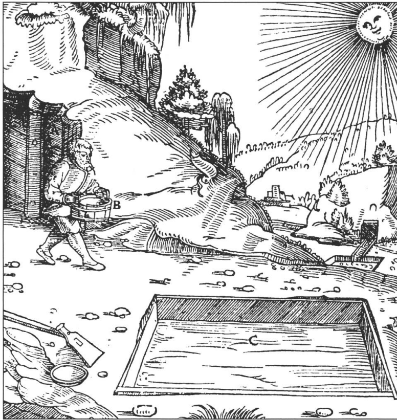
Fig. 1: Holzschnitt aus dem Buch de re metallica von Georgius Agricola (1494–1555): Kupfersulfat-Lösung wird in Bottichen aus einem Stollen in ein Becken zur Aufkonzentrierung (mit Hilfe von Sonnenwärme) transportiert. Im Hintergrund sieht man, wie Minenabwasser direkt in Becken aufgefangen wird.
