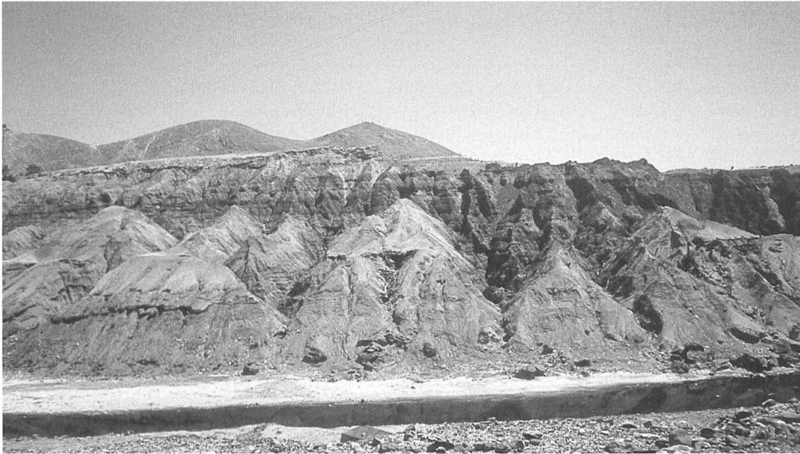
Fig. 2: Abraumhalden (Rio Tinto Mine, Spanien), aus welchen Kupfer mit Hilfe von Bakterien gewonnen wurde (Foto H. Brandl).
