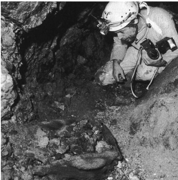
Fig. 12 : Carena TI. Mine Christian I. Galerie de recherche (Strecke) avec au sol, auget en bois in situ encore rempli de son contenu de minerais. (Photographie : D. Morin). En haut auget en bois après restauration (Photographie : Ufficio beni culturali e monumentali, Bellinzona).
