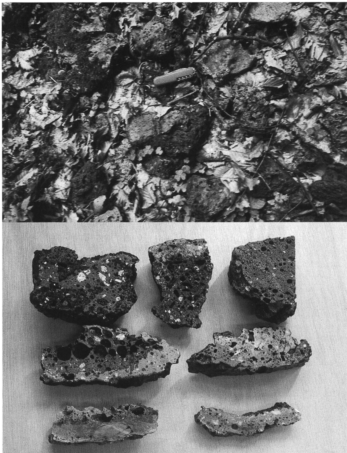
Fig. 2 : Les laitiers de Carena: a) sur le terrain. b) vue en coupe.
