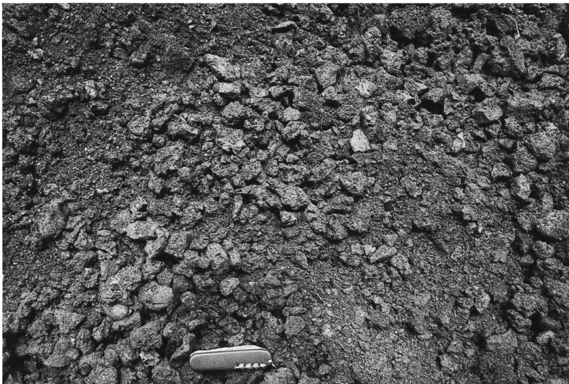
Fig.7 : Les scories grises denses (affinage ?) de Carena.
