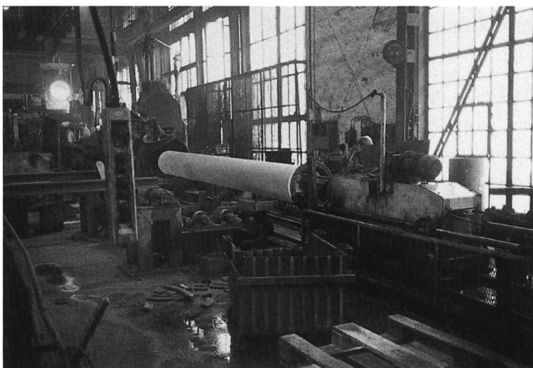
Abb. 2: Die Röhren unmittelbar nach dem Schleudern beim Herausziehen aus der Form. (Foto R. Kündig).
