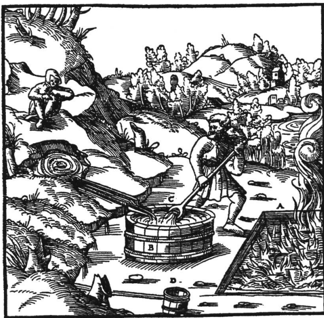
Fig. 5 : Exploitation de la muire : A Tranchée. B Tonneau dans lequel l'eau salée est dérivée. C Pucieux. D Seau fixé à une perche. (d'après Agricola).
