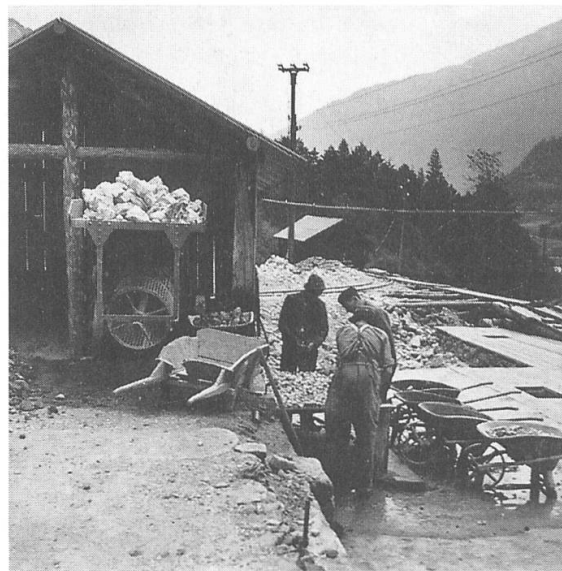
Figure 9: Le tri séparant le quartz et la calcite de la fluorine était manuel. Sur la gauche est installé le concasseur. (Photo G. de Weisse, 1942).
