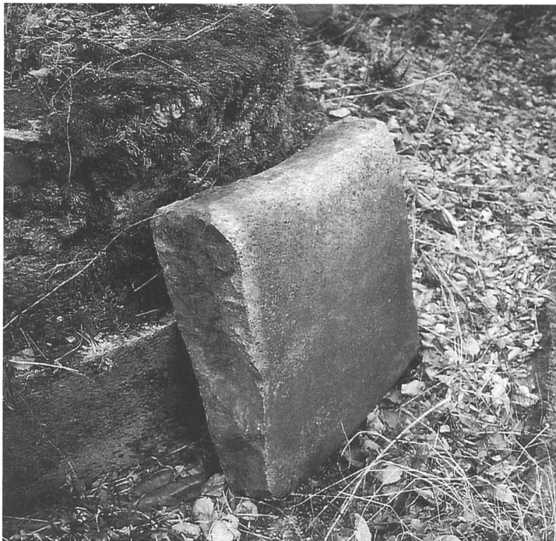
Abb. 18: Vertikal gestellter Schleppstein im stark abgenutzten Boden einer Arstramühle. Foto Hans-Peter Bärtschi, Winterthur, 1988.
