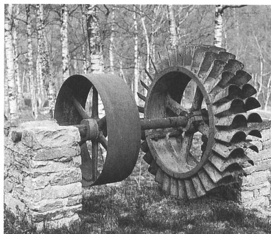
Abb. 22: Laufgrad mit Riemenscheibe, museal aufgestellt im Minenboden. Foto Hans-Peter Bärtschi, Winterthur, 1995.
