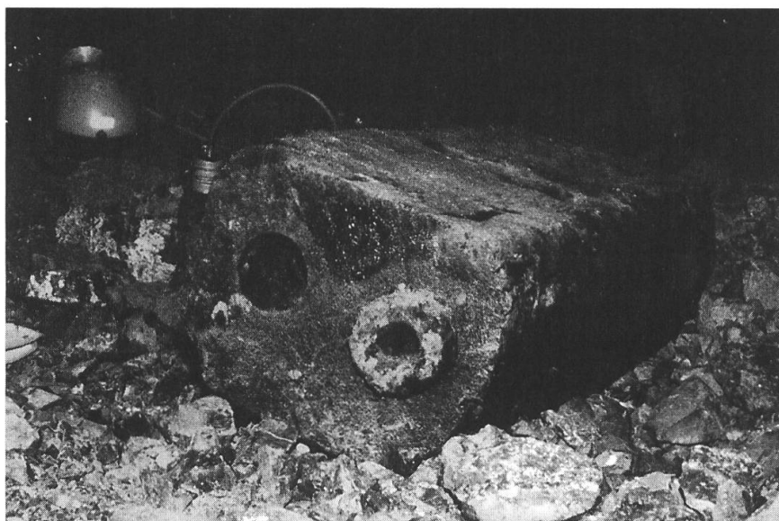
Kolbenpumpe aus dem Mittelalter, welche auf Ober Madlain im Einsatz war. Foto: M. Schreiber.
