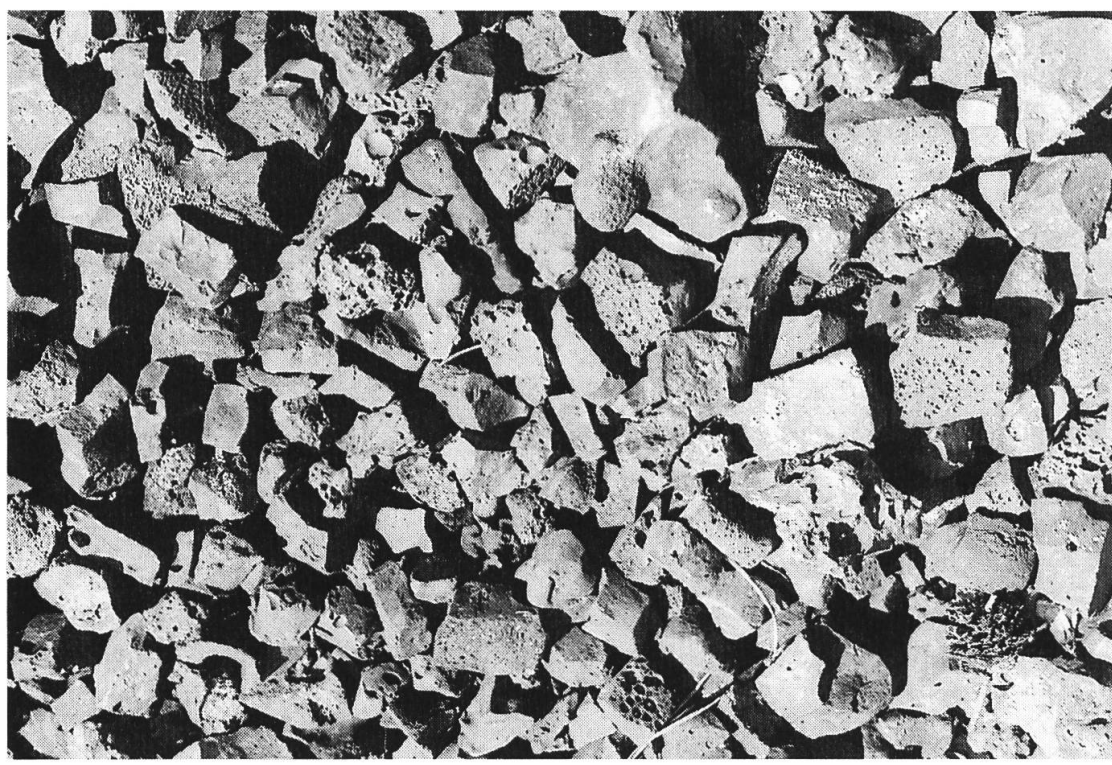
Typische kleinstückige 5 - 30 m/m dicke Plattenschlacke aus dem Oberhalbstein.
