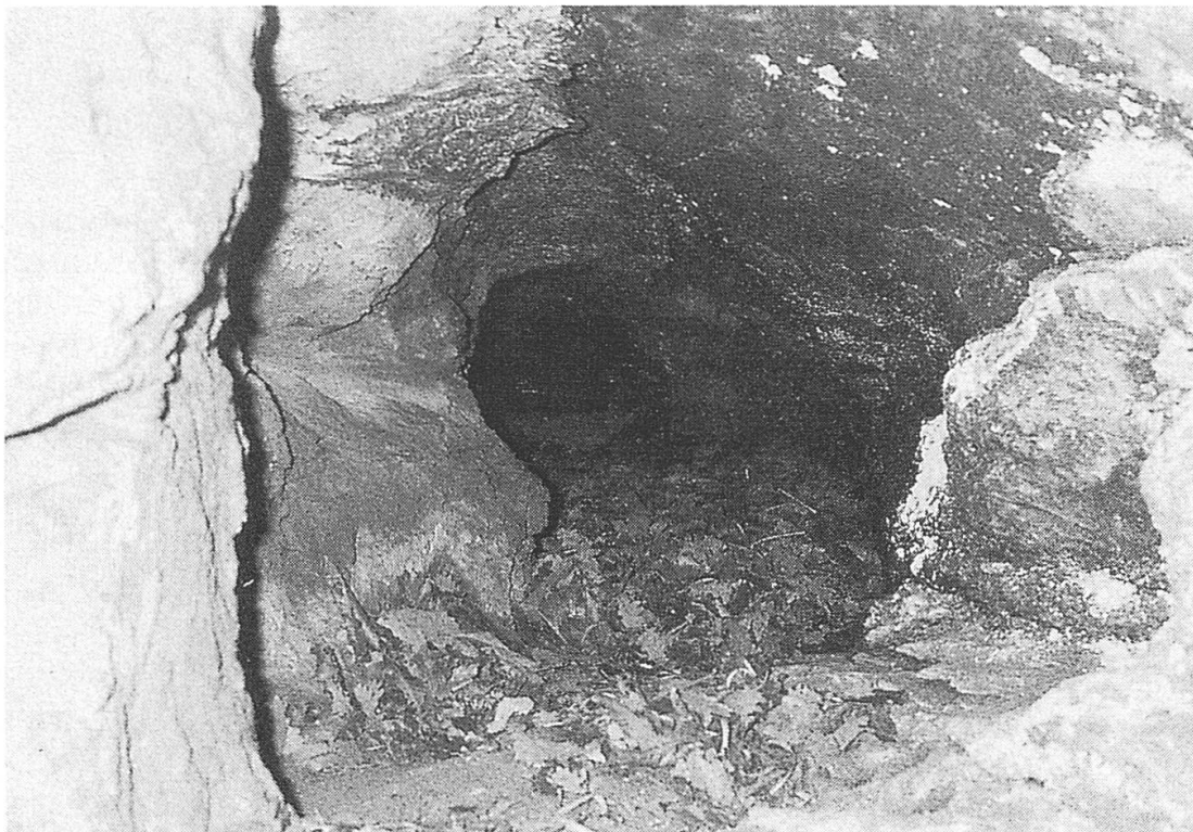
Abb. 2.9: Eingang zum Abbaustollen (Trona) von Foss/Fordecia südlich von Soazza/ Mesolcina. Der kleine Durchmesser (max. 1m) erlaubte höchstens auf den Knien zu arbeiten.
