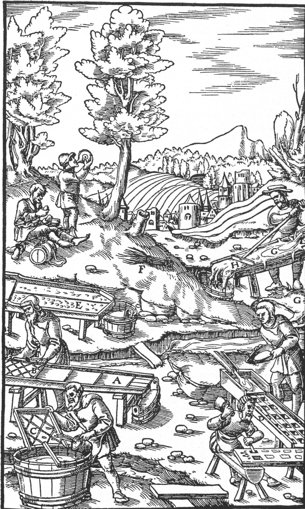
A : Toile de lin couvrant la claie B : Tête de la table garnie de cavités et de rigoles C : Cette partie enlevée qu'on lave dans un récipient D : Table ayant des trous carrés E : Planche rugueuse sur laquelle des petits copeaux adhèrent F : Balai G : Peau de bœuf H : Rouable en bois
