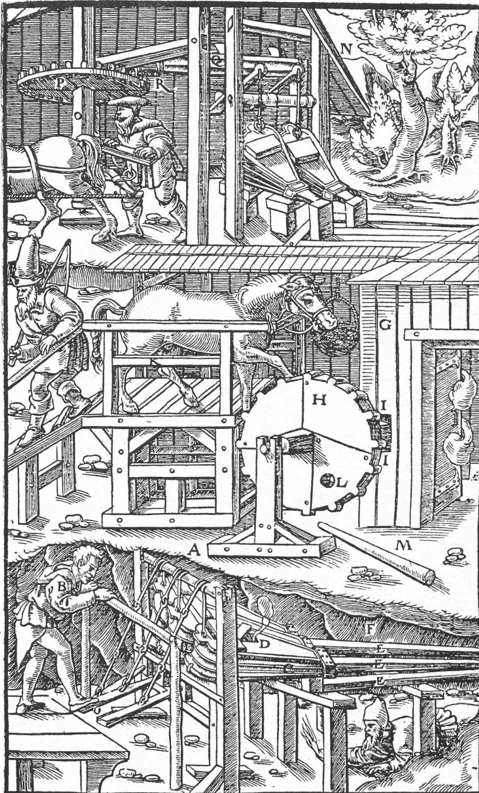
A : Machine décrite en premier B : Homme actionnant le soufflet au pied C : Soufflet sans nez D : Trous par lesquels les vapeurs et odeurs pestilentiellees sont rejetées E : Conduits F : Galerie G : Deuxième machine H : Roue en bois I : Degrés K : Banc en bois L : Trou dans la roue M : Tige N : Troisième machine O : Axe vertical P : Tambour denté Q : Axe horizontal R : Lanterne
