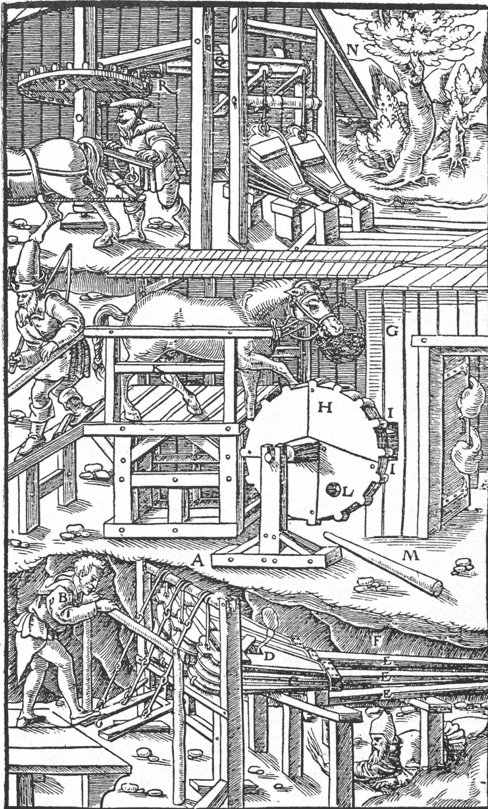
A : Machine décrite en premier B : Homme actionnant le soufflet au pied C : Soufflet sans nez D : Trous par lesquels les vapeurs et odeurs pestilentiellles sont rejetées E : Conduits F : Galerie G : Deuxième machine H : Roue en bois I : Degrés K : Banc en bois L : Trou dans la roue M : Tige N : Troisième machine O : Axe vertical P : Tambour denté Q : Axe horizontal R : Lanterne
