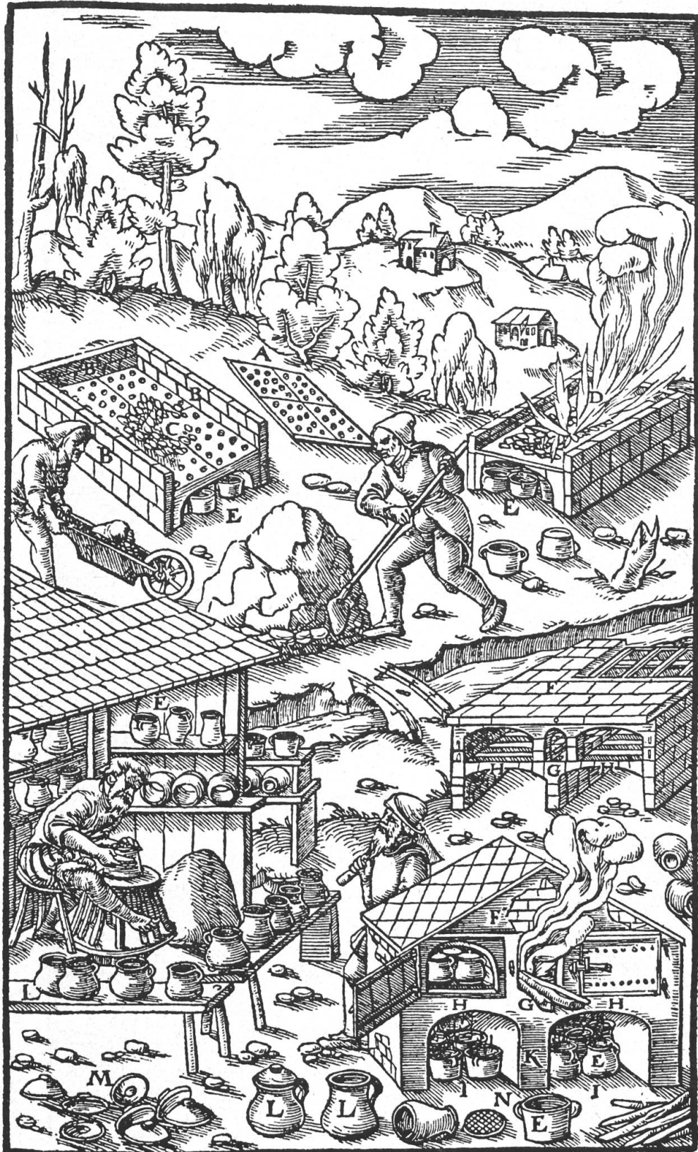
A : Plaque de fer perforée B : Les murs C : La plaque qui reçoit le minerais D : Charbons ardents placés au-dessus du minerais E : Les pots F : Un fourneau G : La chambre du milieu à l'étage supérieur H : Les deux autres compartiments I : Les deux chambres de la partie inférieure K : Le mur du milieu L : Pots qui sont remplis de minerais M : Leurs couvercles N : Leur fond en treillage
