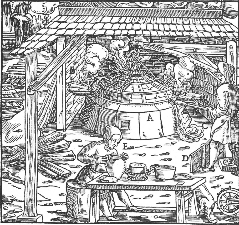
A : Fourneau B : Le bois de chauffage C : La litharge D : Planchettes E : Pour que les exhalaisons qui s'échappent du creuset ne l'empoisonnent pas, le maître mange du beurre, qui est le remède spécial contre ces poisons
