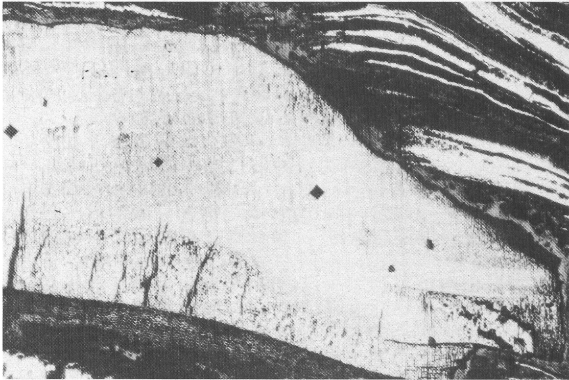
Bild 3. Schliffbild von Schlacke, 90-fach vergrössert. Fundort Castels. C-14-Alter: 2080 \pm 100 Jahre. Gonzenerz-Einschluss in geschichteter Laufschlacke.
