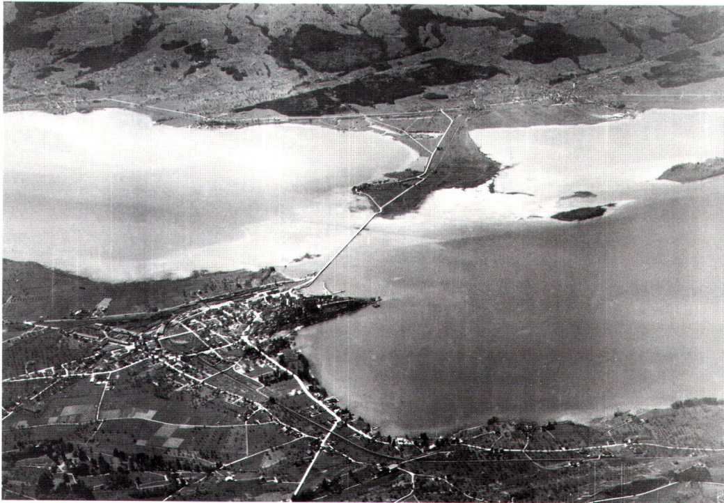
Abb. 2: Flugaufnahme aus dem Jahr 1938. Die seichten Zonen zwischen Rapperswil und der Hurdener Landzunge zeichnen sich deutlich als helle Flächen im Wasser ab. Die dunkle Linie zeigt die heute noch benutzte, ursprünglich für die Lastschifffahrt abgebaggerte Rinne. (Slg. Photoswissair Nr. M1-006012, Bewilligung durch Luftbild Schweiz, Dübendorf).
