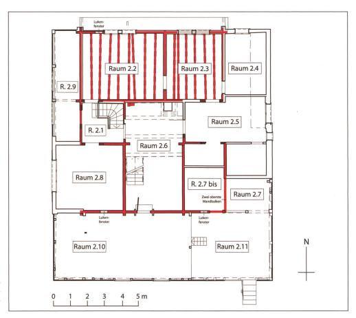
Abb. 3: Grundriss des zweiten Wohngeschosses (Stand während der Bauuntersuchung). Der beobachtete bauzeitliche Kernbau ist rot eingefärbt.
