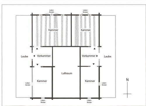
Abb. 13: Schwyz/Ibach, Oberschönenbuch 46. Rekonstruktion des zweiten Wohngeschosses, erfolgt aufgrund der beobachteten Befunde und der Analogie zu anderen zeitgleichen Bauten.
