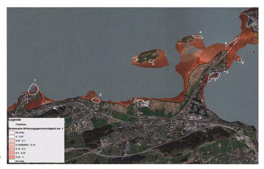
Abb. 4: Darstellung der bodennahen Strömungsgeschwindigkeiten.
