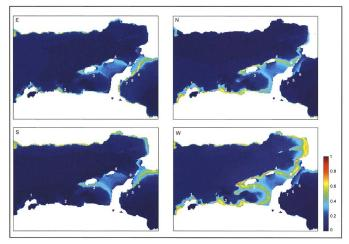
Abb. 5: Bodennahe Strömungsgeschwindigkeiten in Bezug auf die Hauptwindrichtungen bei einer Windstärke von 10 Beaufort.
