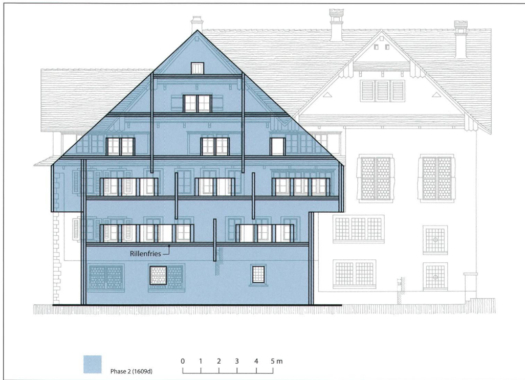
Abb. 5: Rekonstruktionsvorschlag des zweiten Baus, 1609 dendrodatiert, Erhöhung des Dachraumes.
